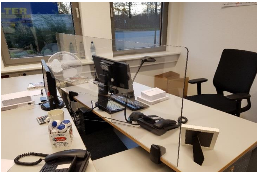
Infektionsschutzwand für Einzelschreibtische. Befestigung mit 2 Klemmhaltern, variabel an die Tischplattenstärke einstellbar. Plattenstärke: je nach Größe 4, 6 oder 8 mm
